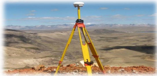
Georreferenciación y control de redes geodésicas
